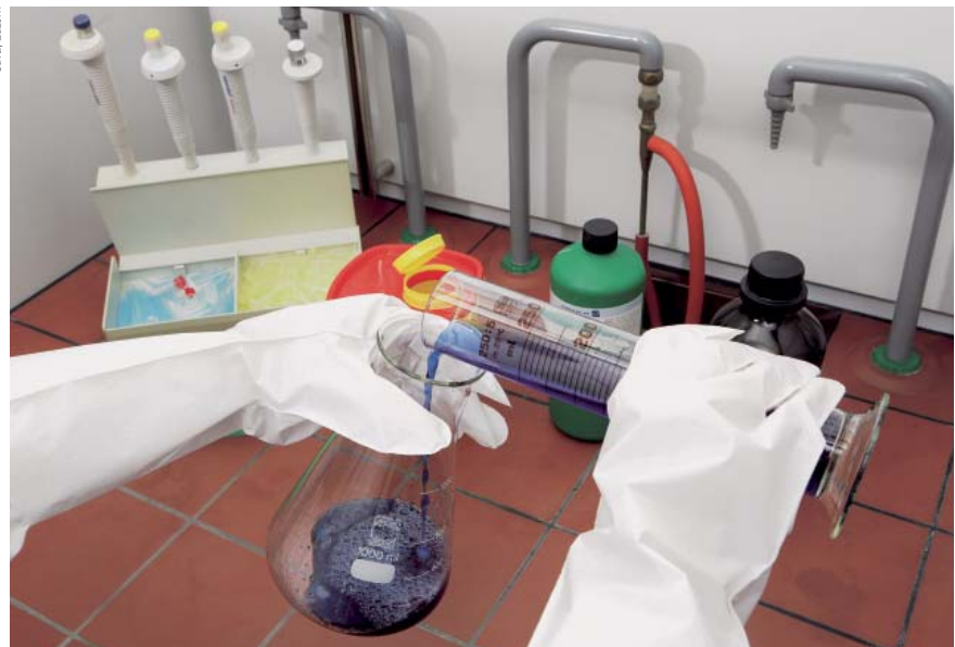
Abb. 2: Bei Arbeiten mit hautreizenden, ätzenden oder allergisierenden Stoffen sind spezielle, chemikalienbeständige Handschuhe unverzichtbar.
